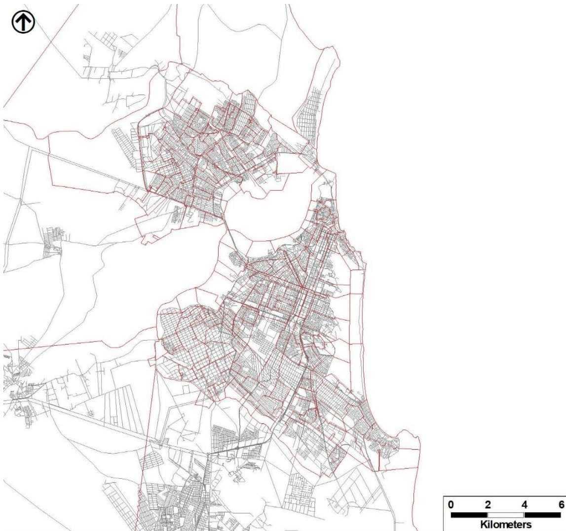
Figura 31 – Representação do sistema viário com links, nós e o zoneamento em Natal
